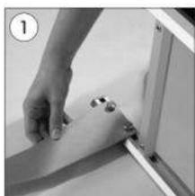
Assemblez les pieds avec la structure en aluminium avec la visserie fournie.
